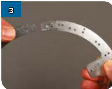
Соедините детали (DF-17) и (DF-18) так, чтобы трапециевидный шип на конце одной из них вошёл в соответствующий паз на конце другой.
