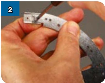
Привинтите накладку (DF-08) к свободному концу детали (DF-18), наложив её с той же стороны, что и уже установленную деталь (DF-08).
