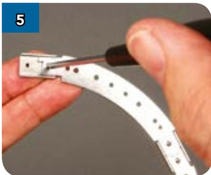
Следуя инструкции шага 2, закрепите вторую накладку (DF-08) на свободном конце детали (DF-17).
