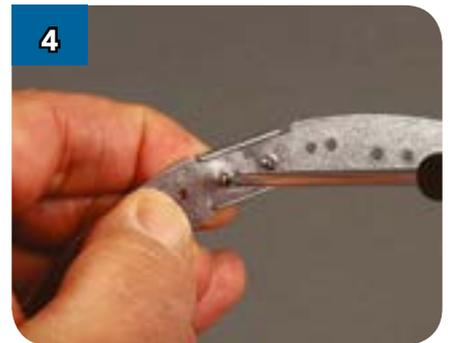
Соедините одним из винтов конец детали (DF-17) и накладку (DF-08).
